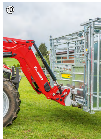
⑩ Transporte mediante puas porta-palets
