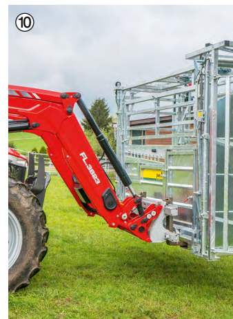
⑩ Transport mittels Palettengabel
