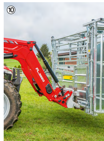
10 Transport doormiddel van pallettenvork
