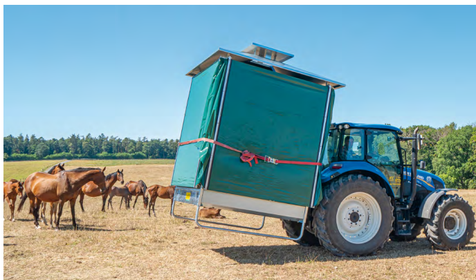
Transport über Dreipunkthanähung, ungefüllt mit max. 10 km/h, mit eingeklappten Dachsegmenten
