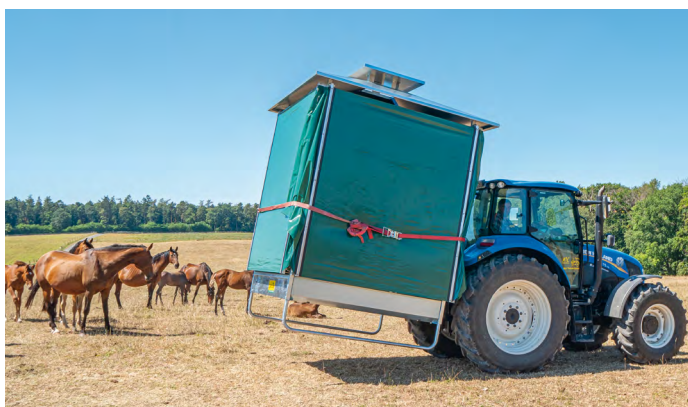
Transport via driepuntsophanging, ongevuld met max. 10 km/uur, met ingeklapte daksegmenten
