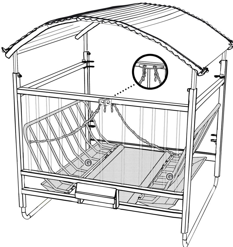
f. Montieren Sie die beiden Fresskörbe **G** auf beiden Seiten der Raufe unter Verwendung von je 2 Scharnierbolzen  $\varnothing 16 \times 150$ . Sichern Sie jeden Scharnierbolzen mit 2 Splinten.
