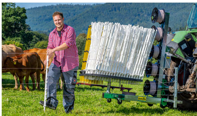
Plataforma intercambiable para hasta 400 postes
