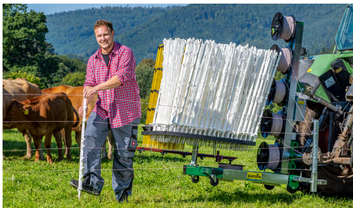
Wechselbares Magazin für bis zu 400 Pfähle
