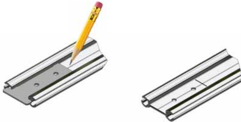
Abbildung 5b, Zugstäben markieren
