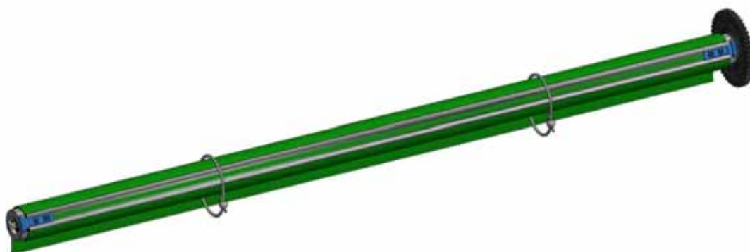
Figuur 11c, Bovenbuis monteren
